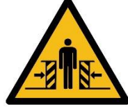
1.1.2 Fig. Crushing Hazard
